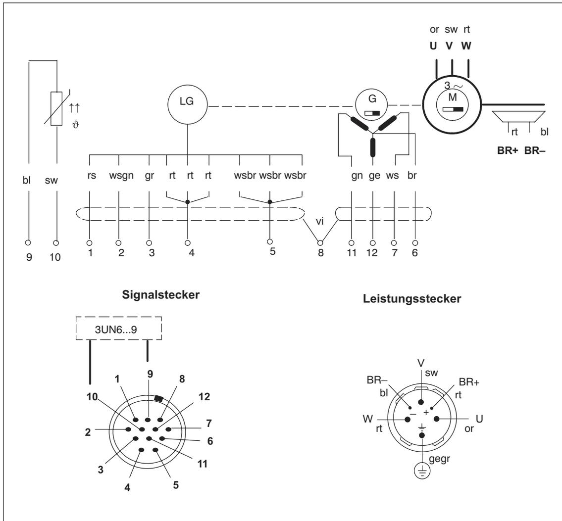
Bild 1-2 Anschlussbelegung: Leistung, Bremse, Tachogenerator, Encoder und Temperaturfühler
